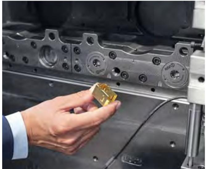
Schirmbleche gehören zu beliebten Produkten, die auf Bihler-Linearmaschinen gefertigt werden.
