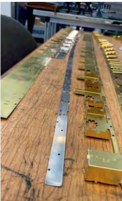
Auf Linearmaschinen von Bihler wird gestanzt, gebogen und umgeformt so schnell das Auge sehen kann.
